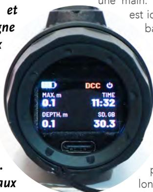
bague rotative autour de la caméra et un bouton poussoir sur le dessus. La bague rotative permet de choisir parmi les différentes fonctions disponibles. Le bouton poussoir s'actionne par des pressions courtes ou longues pour rentrer dans les menus de la Vaquita et valider les paramètres à modifier. C'est aussi lui qui permet d'allumer / éteindre la caméra et lancer / arrêter les séquences vidéos.
