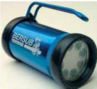
Ce phare à LED est actuellement le plus puissant du marché grâce à 8 LED de 4 W. Son pack d'accus de très haute capacité (14,4 V - 4,5 Ah) lui autorise une autonomie de 4 heures (dont 3 heures à 100% de puissance). Son poids (dans l'air) est de 1500 grammes pour un volume ultra compact de 8 cm de diamètre par 16 cm de long. Un produit de grande qualité et d'une puissance surprenante...
