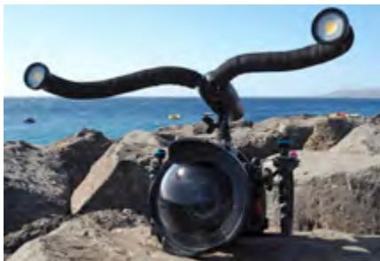
lief aux images. En croisant les faisceaux on augmente l'intensité lumineuse si on a besoin d'un éclairage plus fort pour une prise de vue particulière. Les bras articulés s'orientent facilement et sont protégés par un revêtement en néoprène. Le compartiment batterie possède une fixation de type
