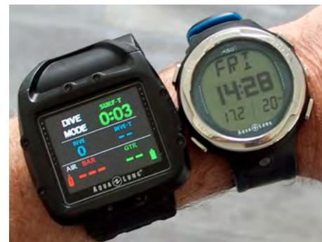
les fonctions d'un ordinateur haut de gamme de plongée loisir pour des immersions avec décompression à l'air, au nitrox, en plongée libre (apnée), en mode profondeur simple, en eau douce ou eau de mer, en altitude,... De nombreuses options sont paramétrables pour s'adapter aux exigences de certains plongeurs (plongée multigaz, palier profond, intégration d'une sonde de gestion d'air,...), et
