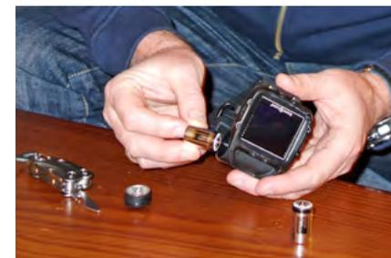
pile de rechange pour ne pas être pris au dépourvu. Toutes les données, les réglages personnalisés, le carnet de plongée et les calculs de décompression sont conservés lors du changement de la batterie. L'i750TC peut être connecté à l'application gratuite DiverLog (disponible sur IOS et Android), par cordon ou par Bluetooth pour effectuer des mises à jours, piloter les réglages de l'ordinateur, analyser le profil des plongées et gérer l'historique des immersions.
