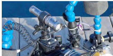
sante pour les plongées de nuit et une lampe pilote pour une aide à la mise au point de leur appareil photo, le mini-phare i-Torch V10 est fait pour eux. Avec ses 1000 lumens, son autonomie d'une heure, ses 3 puissances en lumière blanche (100%, 50%, 25%), son large faisceau homogène (100° sous l'eau et sans point chaud), sa compacité (121mm de long x 30mm de diamètre), son poids plume (170 gr)
