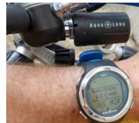
option) qui se visse sur le détenteur à la place d'un classique manomètre pour vous offrir la fonction supplémentaire de gestion des gaz. Ce dispositif sans fil est vraiment appréciable, confortable et renforcera votre sécurité. Le couplage des deux éléments est simple à réaliser et à faire qu'une seule fois pour toute la durée de vie de votre i450T.
