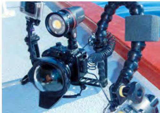
permettant d'avoir accès à différentes puissances d'éclairage (5 en mode blanc et 2 en mode rouge). Le mode d'éclairage en rouge, très utile pour approcher la faune de nuit se fait par 3 petites leds situées sur les contours de la parabole. Son étanchéité est assurée par 2 joints et
