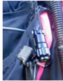
et son étanchéité est assurée par 2 joints toriques. Son faisceau est étonnamment large avec une lumière blanche agréablement diffuse sur les bords. En mode basse intensité, cette mini-lampe est suffi-
