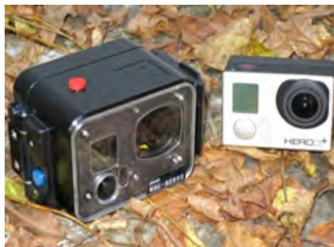
profonde. Les 2 hublots (de l'objectif et de l'écran) sont en acrylique épais et les commandes en POM. Sous le caisson on trouve 2 pas de vis standard « kodak » pour pouvoir
